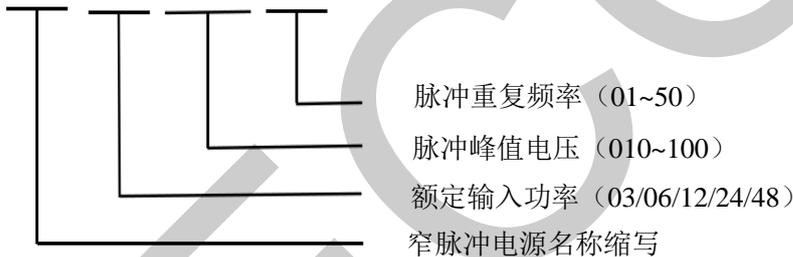
示例：NPS-06-045-20 表示额定功率 6 kW，脉冲峰值电压 45 kV，重复频率 2 kHz。
