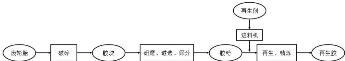
图 1 再生橡胶生产工艺流程图示意图
