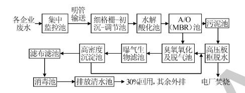
出水水质: SS、BOD<sub>5</sub>、COD、色度的总去除率分别达到 98.0%、95.9%、92.9%、94.8%, 出水水质达到《城镇污水处理厂污染物排放标准》 (GB18918—2002) 一级 A 排放标准
