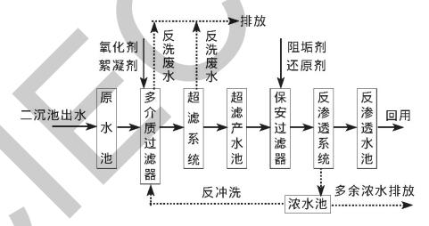
水质情况: 进水 pH 7.4, COD80 mg/L, SS 15 mg/L, 色度 26 mg/L, 电导率 2750 μs/cm, ; 回用水 pH 6.8, COD7.5 mg/L, SS 未检出, 色度 2 mg/L, 电导率 32 μs/cm
