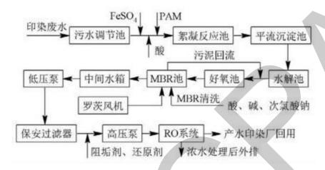
出水水质: pH 6.5 8.5, COD < 50 mg/L, 色度 < 15 倍, 电导率小于 < 0.5 ms/cm。
